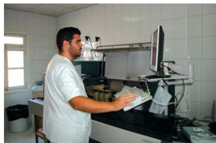
Tècnic de laboratori treballant amb el Milkoscan 4000. S'analitza la composició química i el recompte de cèl·lules somàtiques en la llet.
