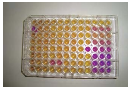
Placa microtiter Eclipse 100. Test qualitatiu per a la detecció de substàncies inhibidores de la llet, amb cultiu d'espores de Geobacillus stearothermophilus . Després de la incubació a 65 °C, el microorganisme creix acidificant el mitjà i produint el viratge del color blau del medi a un color groc.
