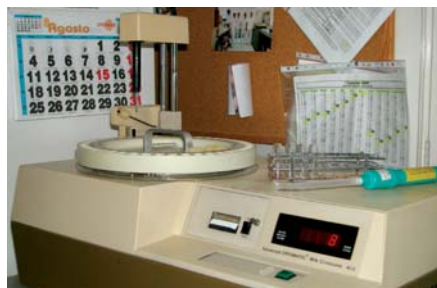
Crioscòpic que determina el punt de congelació de la llet, per tal d'evitar l'adulteració amb aigua.
